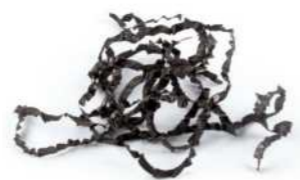
无断屑槽 without chipbreaker
