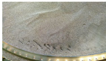
图4 设备振动筛网常见破损部位及形态
